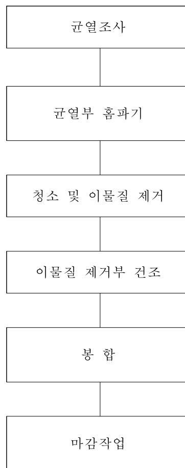
<그림 4.2.14> 교면포장 아스팔트 균열보수
